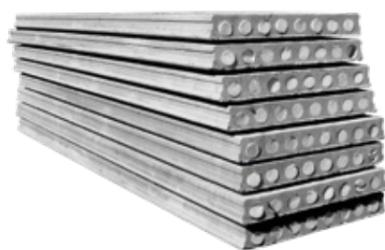
A laje alveolar de concreto protendido apresenta alta resistência e grande durabilidade. Ideal para grandes vãos, sobrecargas elevadas ou obras que necessitam de tempo de execução reduzido, pois dispensam a utilização de escoramento liberando rapidamente a obra para os serviços de acabamento. Seu acabamento inferior é liso, não sendo necessário nenhum tipo de revestimento, e na face superior é recomendado o capeamento com tela soldada para melhor distribuir as cargas.
